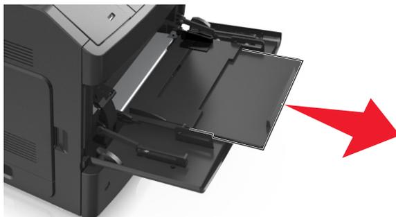
**Примечание.** Осторожно продвиньте раскладную часть таким образом, чтобы полностью выдвинуть и открыть многоцелевое устройство подачи.
