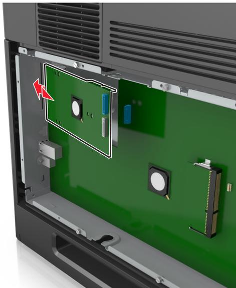
**Примечание.** Расположите порт ISP под углом к пластмассовой вставке, чтобы все свешивающиеся разъемы прошли через отверстие ISP в корпусе системной платы.
