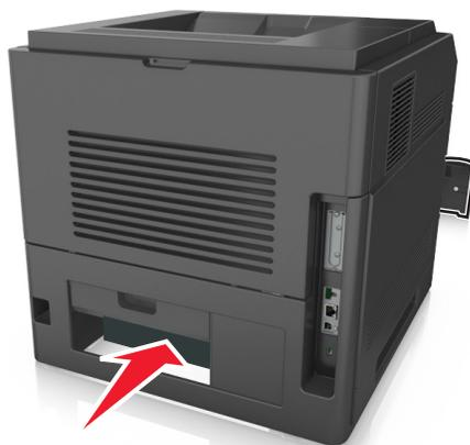
5 Нажмите на клапан задней части блока двусторонней печати, крепко возьмитесь за замятую бумагу и осторожно вытяните ее.
